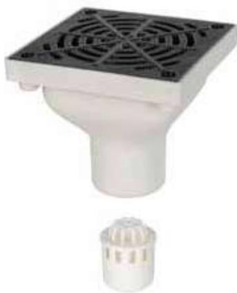
Realizzato in poliestere rinforzato con fibra di vetro – GFK. L'alternativa alle pesanti scatole di ingresso in cemento o cemento polimerico. Con sifone e raccordo di scarico NW 100.
