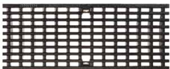
Grata longitudinale , ghisa, rivestita con KTL Classe di sollecitazione: D400*, E600*, Lunghezza: 50 cm, LM 25 x 11 mm
