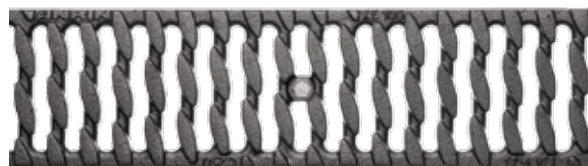
Grata scanalata, design OvalGrip , ghisa, rivestita con KTL Classe di sollecitazione: C250, E600*, Lunghezza: 50 cm, LF 10 mm
