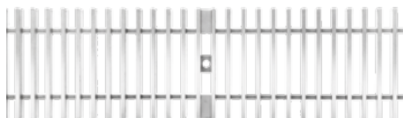
Grata trasversale , acciaio zincato, acciaio inox Classe di sollecitazione: B125, Lunghezza: 50 cm, 100 cm, LF 13 mm
