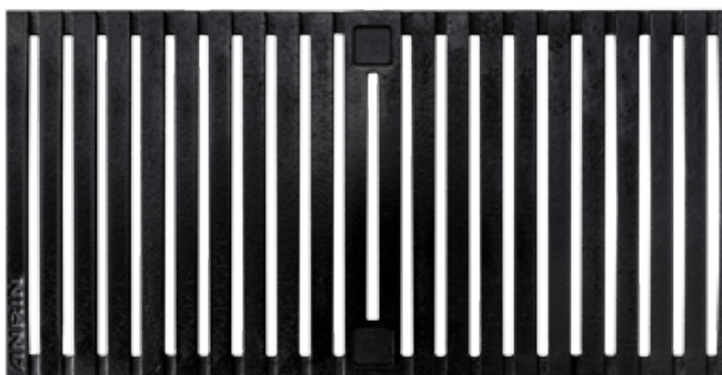
Grata scanalata, HEELGUARD , ghisa, rivestita con KTL, laccata nera Classe di sollecitazione: D400*, Lunghezza: 50 cm, LF 6 mm
