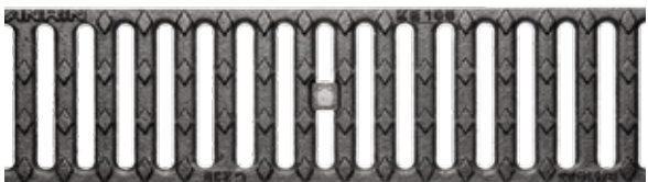
Grata scanalata SW 10 , ghisa, laccata nera Classe di sollecitazione: C250, Lunghezza: 50 cm, LF 10 mm
