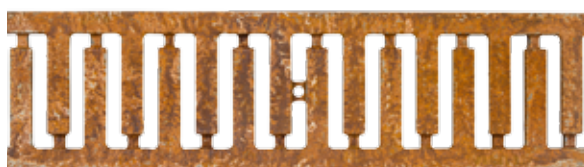
Grata scanalata, MASSIV 32 , ghisa, non rivestito Classe di sollecitazione: E600*, Lunghezza: 50 cm, LF 11 mm
