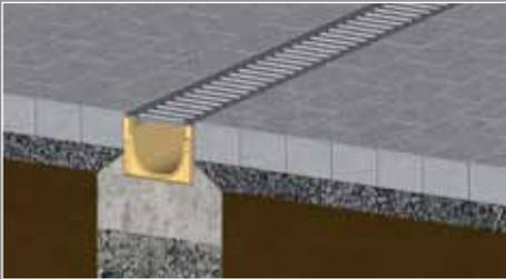
Posare la pavimentazione. Il rivestimento dovrebbe risultare da 2 a 5 mm più alto rispetto alla griglia di copertura.
