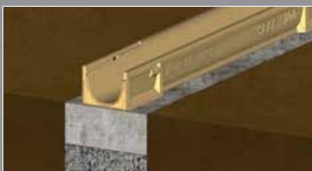
Applicare la fila di canali, i pozzetti di scarico e i frontali sul letto di calcestruzzo.
