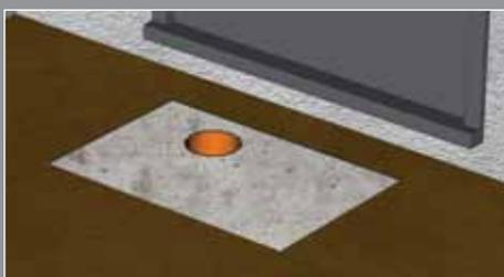
Preparare il fondo in modo tale che il bordo superiore del nettascarpe comfort arrivi a filo del bordo superiore del rivestimento finito. Avvicinare l'eventuale tubazione da collegare.
