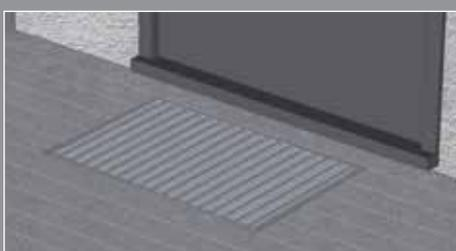
Inserire la griglia di copertura e posare la pavimentazione circostante.
